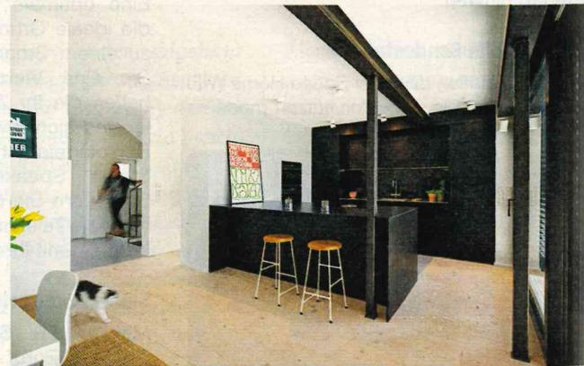
Wo jetzt der Stahlträger verläuft, war zuvor die Außenwand. Auch mit dem Stahlgerüst in der Fassade wird die Dach- und Deckenlaibung abgetragen, das macht die große Fensteröffnung erst möglich.
