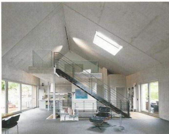
*43.4: Die Wände und das Dach dieses Hauses zeigen, dass sie mit Betonfertigteilen hergestellt sind. Die Oberflächen brauchten keine weitere Behandlung. Auch der Boden besteht aus Beton, hier mit einer Spachtelung veredelt. (Fabi Architekten)*
