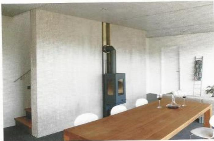
63.4: Dem Kaminofen gehört die ganze Betonwand, hinter der die Treppe verborgen liegt. Die Wand dient als Wärmespeicher. Sie gibt diese Wärme auch nach oben ab, ebenso das Kaminrohr, das frei durchs Obergeschoss hindurchgeführt wird. (Arch.: R S T Richard Stihler)
